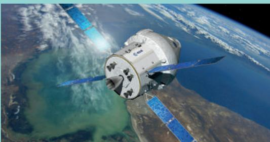
El Módulo de Servicio se encuentra directamente debajo del Módulo de la Tripulación de la nave Orion y proporciona propulsión, potencia, control térmico, agua y aire para cuatro astronautas. Los 4 paneles solares abarcan abarca 19 m y generan suficiente electricidad para abastecer a dos hogares. Mide un poco más de 5 m de diámetro y 4 m de altura, pesa 13.5 toneladas. Las 8.6 toneladas de combustible propulsarán un motor principal y 32 motores más pequeños.
